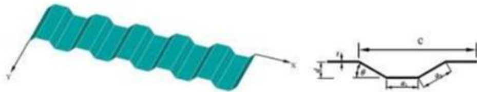
مشخصات هندسی ورق موجدار ذوزنقه ای
