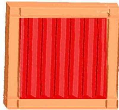
نمایی از یک دیوار برشی فولادی موج دار به همراه قاب پیرامونی
